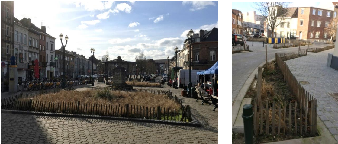
Figure 53 : Parterres plantés sur la place de Saint-Denis (à gauche) et jardins de pluie sur la rue du Dries (à droite) (ARIES, 2021)
